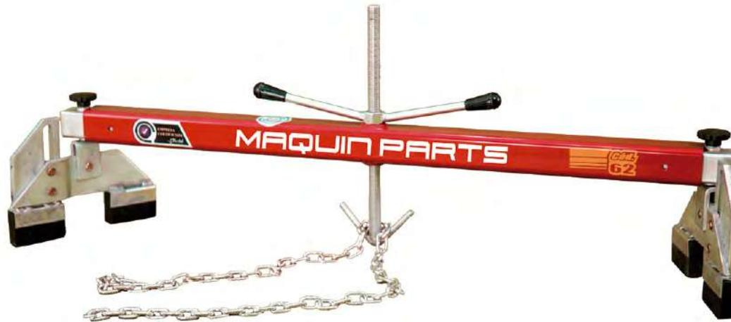
• GRACIAS A LA REGULACIÓN DE LOS BRAZOS TELESCÓPICOS Y AL PIVOTE DE LOS APOYOS DE LOS EXTREMOS, ESTE EQUIPO PUEDE SER EMPLEADO EN CUALQUIER TIPO DE AUTOMÓVIL O CAMIONETA CON MOTOR DELANTERO.
