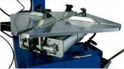
EL PLATO GIRATORIO AUTOCENTRANTE CON CUATRO MORDAZAS GARANTIZA QUE EL NEUMÁTICO SIEMPRE QUEDE FIJADO CORRECTAMENTE.
