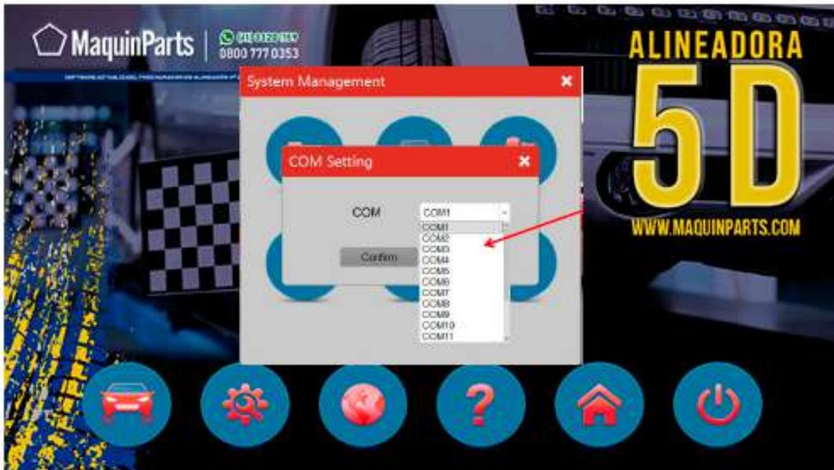
El puerto COM es el canal de comunicación de señales de la máquina, el puerto por defecto es el COM1. . No lo cambie, de lo contrario la máquina no puede trabajar normalmente.
