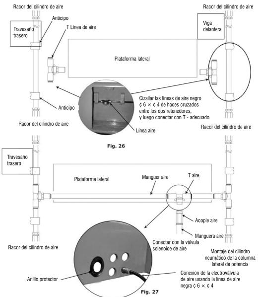
4. Conexión separador de aceite - agua y válvua solenoide.
