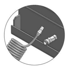
Otro lado de la línea de aire que se muestra en a vista d se conecta a la conexión rápida hembra instalada en la plataforma.
