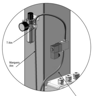
La línea de aire se conecta con el cilindro de aire
