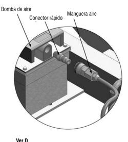
Conecte la conexión hembra de la línea de aire a la conexión rápida macho en la bomba de aire
