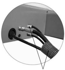
Apriete la manguera de aceite del kit de tubería de aire, la manguera de aceite y la línea de aire del sistema de línea de aire de elevación mediante kits de sujeción y pase a través de la manguera protectora de plástico.
