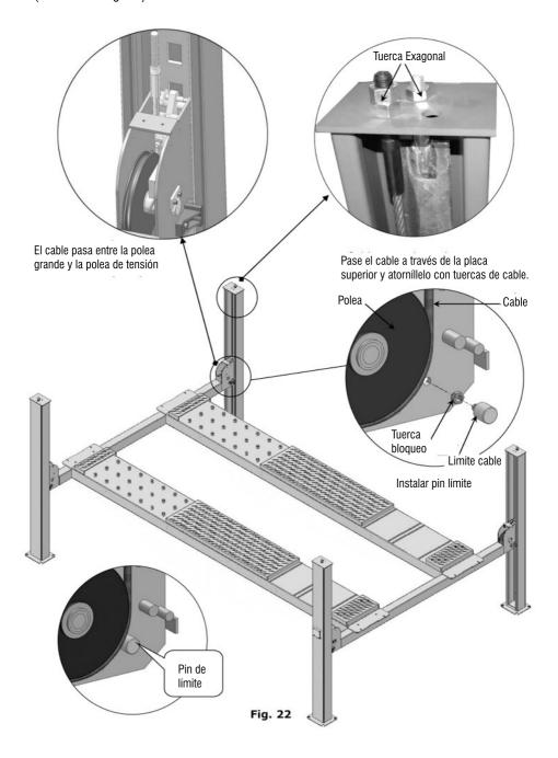
3. Después de que los cables pasen a través de las poleas debajo de la plataforma, instale los pernos de cable suelto No.19 (Vea la Fig. 23
