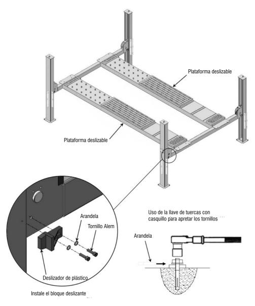
Nota: El par de apriete para el perno de anclaje es 150N.m
