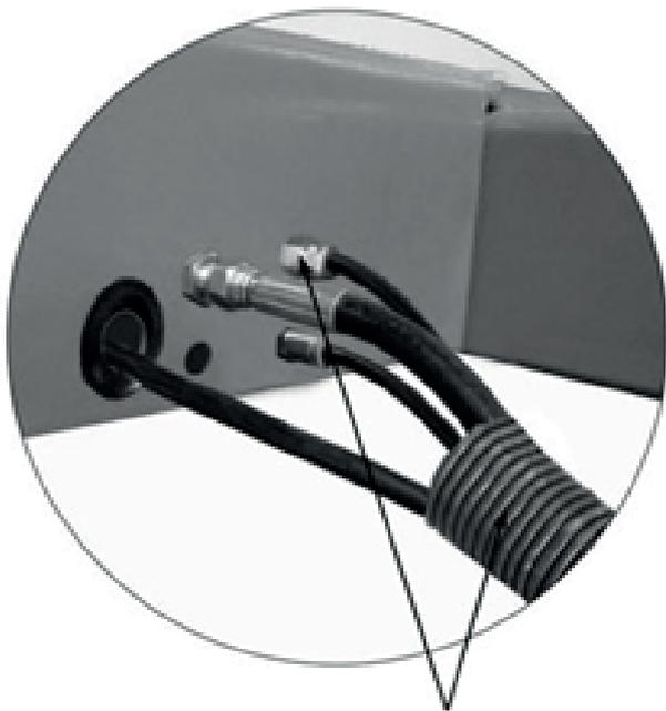
Apriete la manguera de aceite del kit de tubería de aire, la manguera de aceite y la línea de aire del sistema de línea de aire de elevación mediante kits de sujeción y pase a través de la manguera protectora de plástico.
